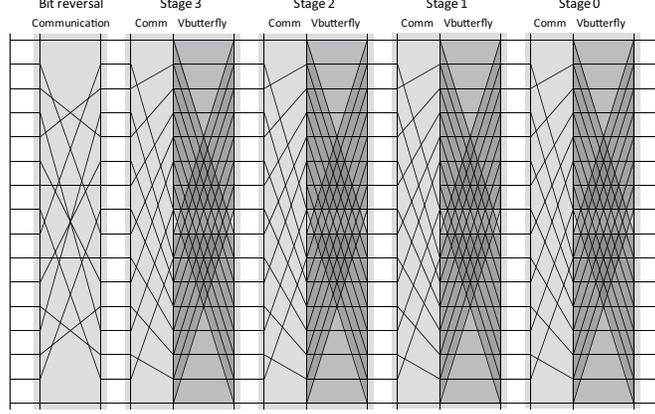
$$R_2^{16} \left( L_8^{16} D_0^{16} (\text{DFT}_2 \otimes I_8) \right) \left( L_8^{16} D_1^{16} (\text{DFT}_2 \otimes I_8) \right) \left( L_8^{16} D_2^{16} (\text{DFT}_2 \otimes I_8) \right) \left( L_8^{16} D_3^{16} (\text{DFT}_2 \otimes I_8) \right)$$
