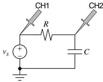
Fig. 1. RC circuit.
