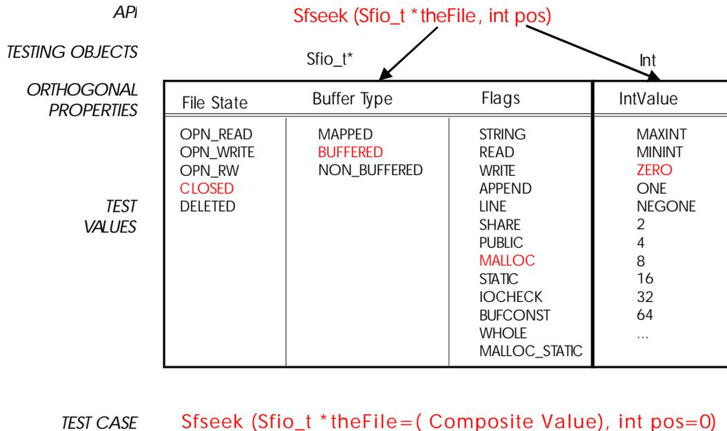
Figure 2. Ballista test parameter creation
